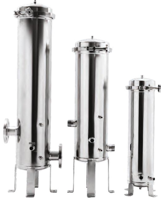
نحو نقوم بإنتاج خزنات فلاتر مصنوعة من الفولاذ المقاوم للصدأ أو الفولاذ الكربوني وفق معدل التدفق ودرجة الحرارة والحجم المطلوب. تعمل الخزنات حتى ضغط أقصى يبلغ ١٠ بار (٤٥ رطل / بوصة مربعة).
